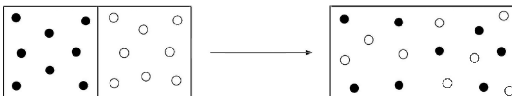
figura 3 Processo de mistura isotérmico e isobárico de dois gases perfeitos distintos. \Delta S > 0
