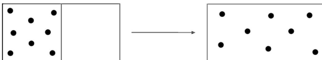
figura 1 Expansão de um gás perfeito contra o vácuo em recipiente isolado. \Delta S > 0 .
