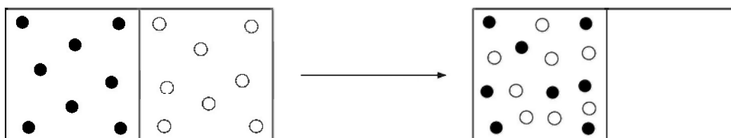
figura 4 Processo de mistura de dois gases perfeitos distintos, em iguais condições físicas, seguida de compressão isotérmica até ao volume inicial. \Delta S = 0 .
