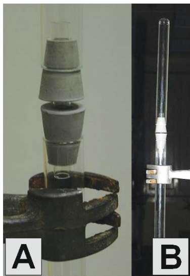
Figura 1 Montagem para a preparação de amoníaco: A - sistema de rolhas usado na montagem e B - montagem completa
