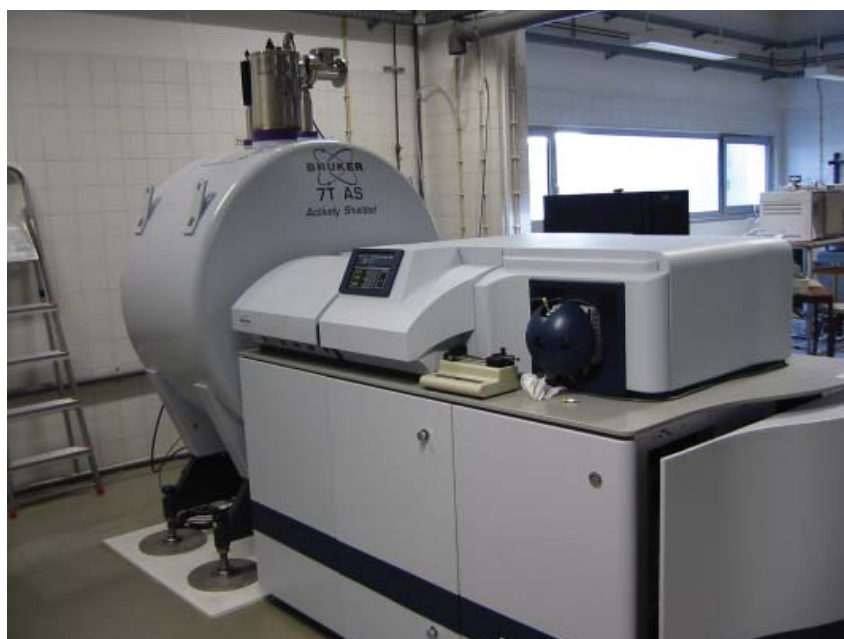
Figura 3 - Espectrómetro de massa de ressonância ciclométrica de ião com transformada de Fourier (FTICR-MS) no Laboratório de FTICR e Proteómica da FCUL. Este equipamento permite determinar massas exactas com elevada resolução. Um exemplo das suas aplicações é a caracterização de proteínas intactas e suas modificações pós-traducionais. Permite ainda estabelecer a composição elementar de moléculas
