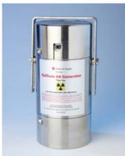
Figura 9 - Gerador de ^{68}\text{Ga} a partir do ^{68}\text{Ge}
