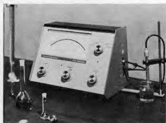
Modelo PYE 291. Escalas 0-14 e 0-2.8 com expansão contínua de 0-14.8.
