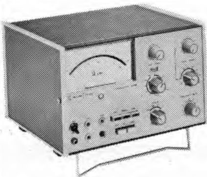
Modelo PHILIPS tipo PW-9501/01. Condutivímetro de leitura directa com ajuste de constante da célula de 0.01-30 \text{ cm}^{-1}
